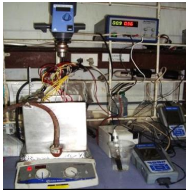
Figura 3. Celda electrolítica con ánodos y cátodos de Hierro.
