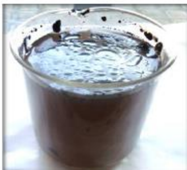
Figura 2. Muestra de fluido de producción tomada directamente del cabezal del pozo de petróleo.
